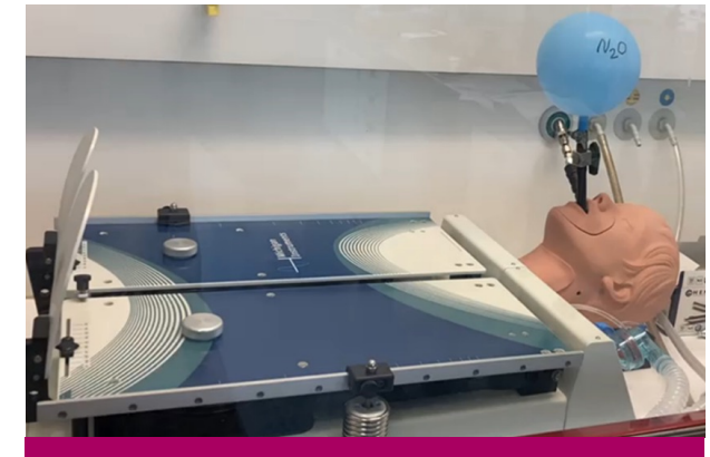
Figuur 2. Foto van ademhalingssimulator gebruikt door TNO.
