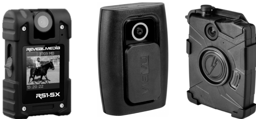
Figuur 8.2: De bodycam van Reveal (links) heeft een beeldscherm waarop de beelden te zien zijn – dus ook voor de persoon die wordt gefilmd. De VIEVU (midden) heeft geen beeldscherm, maar een schuif die de camera activeert waarna een groene cirkel rondom de lens zichtbaar wordt. Aan de Taser bodycam (rechts) is niet te zien of hij aan of uit staat
